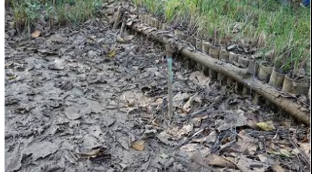
逕流沖蝕觀測區，培地茅+打樁編柵(木樁+竹子)，藍色水管是觀測沉砂池土砂淤形
