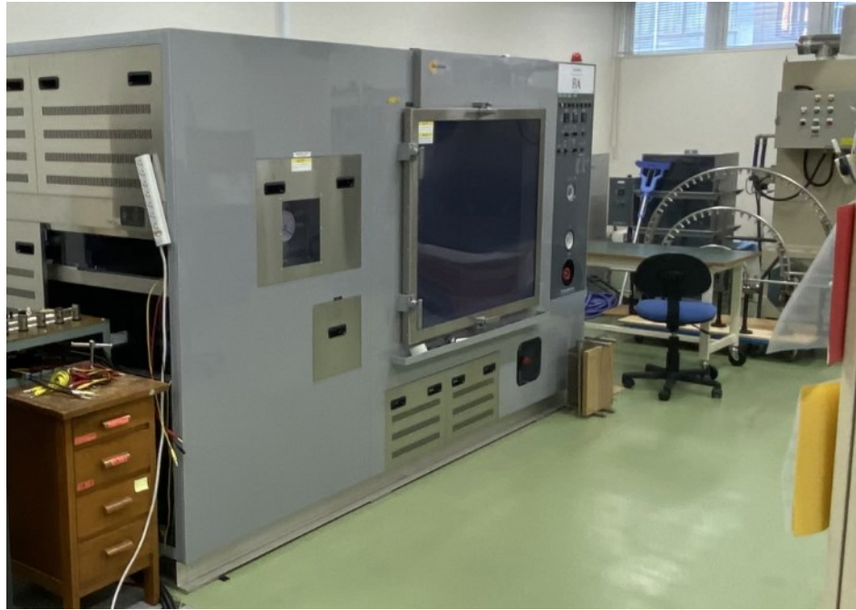
圖 21、耐候性能試驗之防水測試系統
