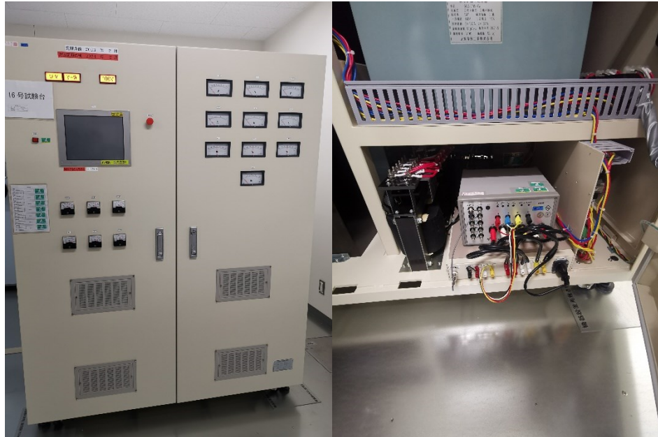
圖 18、JEMIC 自行開發精密試驗台(圖右是內部電力標準器)
