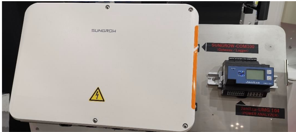
圖 46、Tsuruta 公司 SUNGROW PPSC 系列具滑軌式交流電力分析模組
