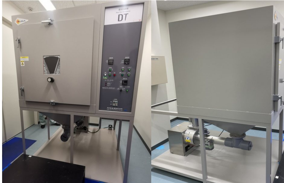
圖 20、具抽氣循環功能之塵埃試驗系統正面(圖左)與側面(圖右)
