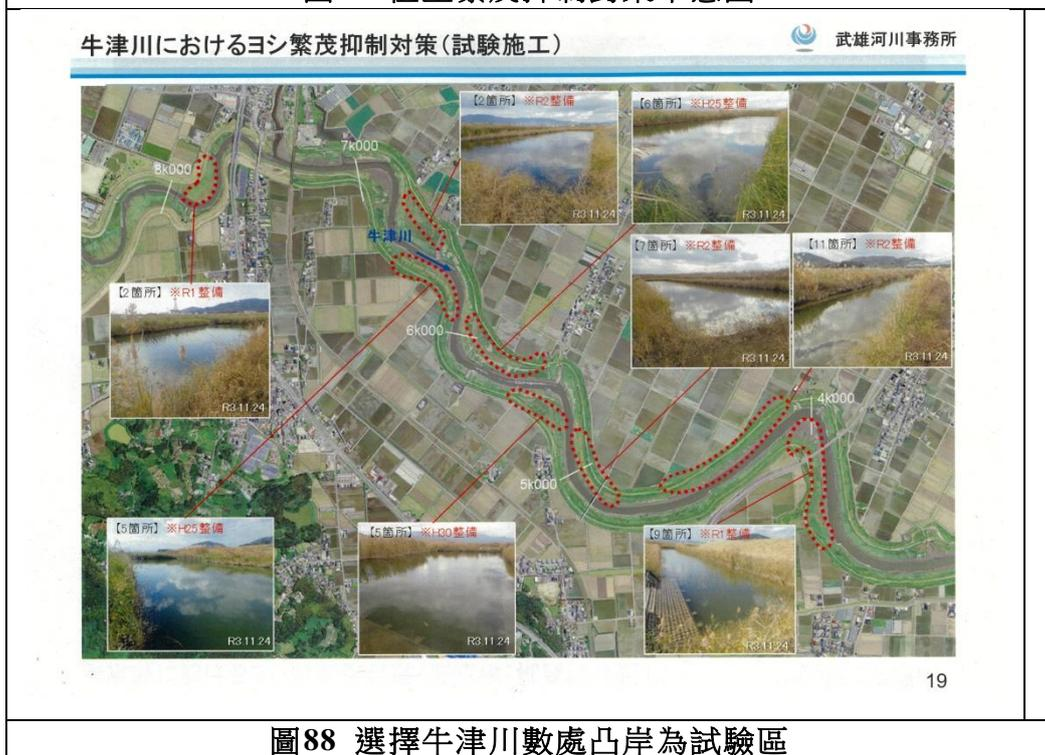
圖88 選擇牛津川數處凸岸為試驗區
