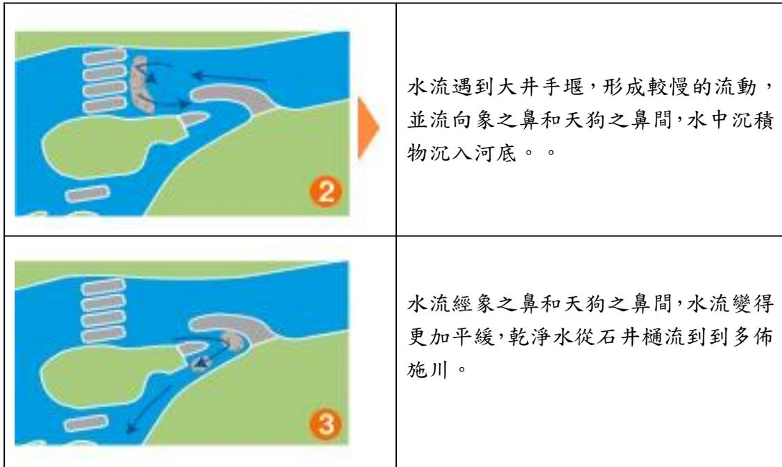
原石井樋設施因上游另有取水設施已無使用，1993年為了慶祝日本皇太子成婚，開始進行石井樋地區水文化歷史的復舊，經過吉村伸一專家研究，推測並繪製河川分流取水系統(圖 68)，並且製作許多模型進行水理試驗，證實石井樋複雜的分流取水方式，2005年為具有水力背景的日本天皇生日，以石井樋修復工程的完成當作賀禮。
