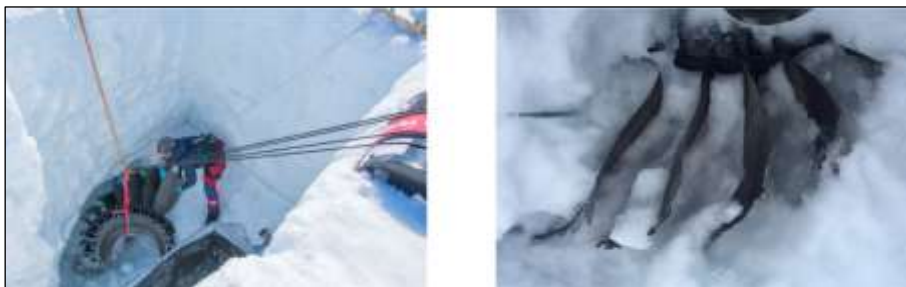
圖 3.2-5 挖掘出發動機關鍵證物
