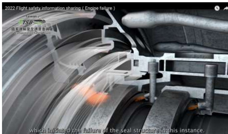
圖 3.3-3 發動機定子及轉子氣/油封發生深磨擦
