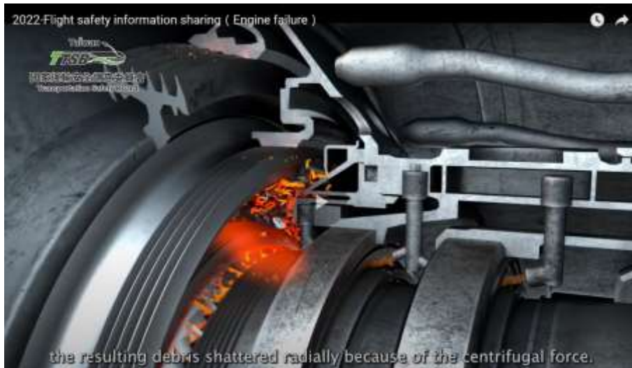
圖 3.3-4 4R 定子及轉子氣/油封受損破裂碎片撞擊 4R 轉子排氣軸封
