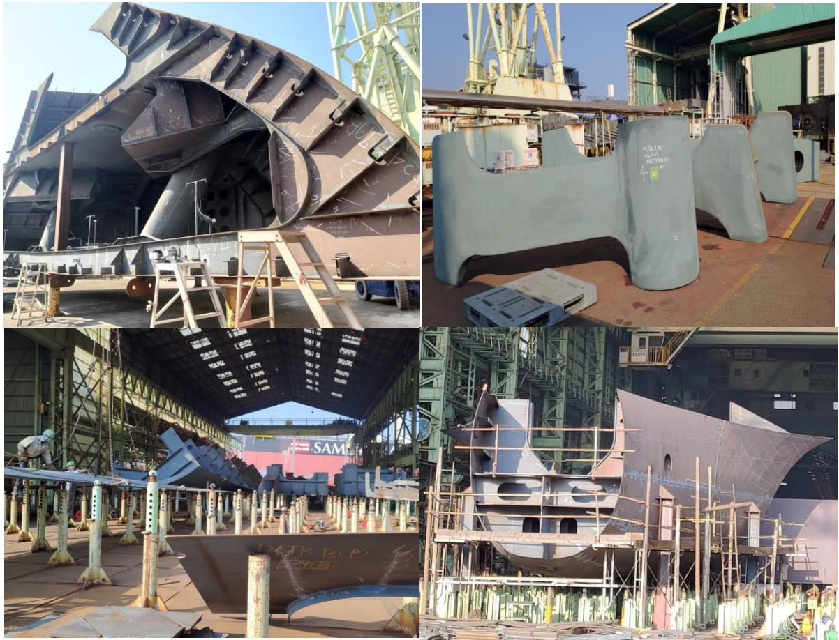
圖 15.已完成切割的澎湖輪船段
