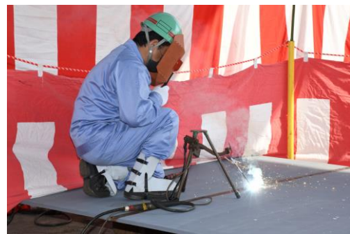
圖 12.澎湖輪船段切割
