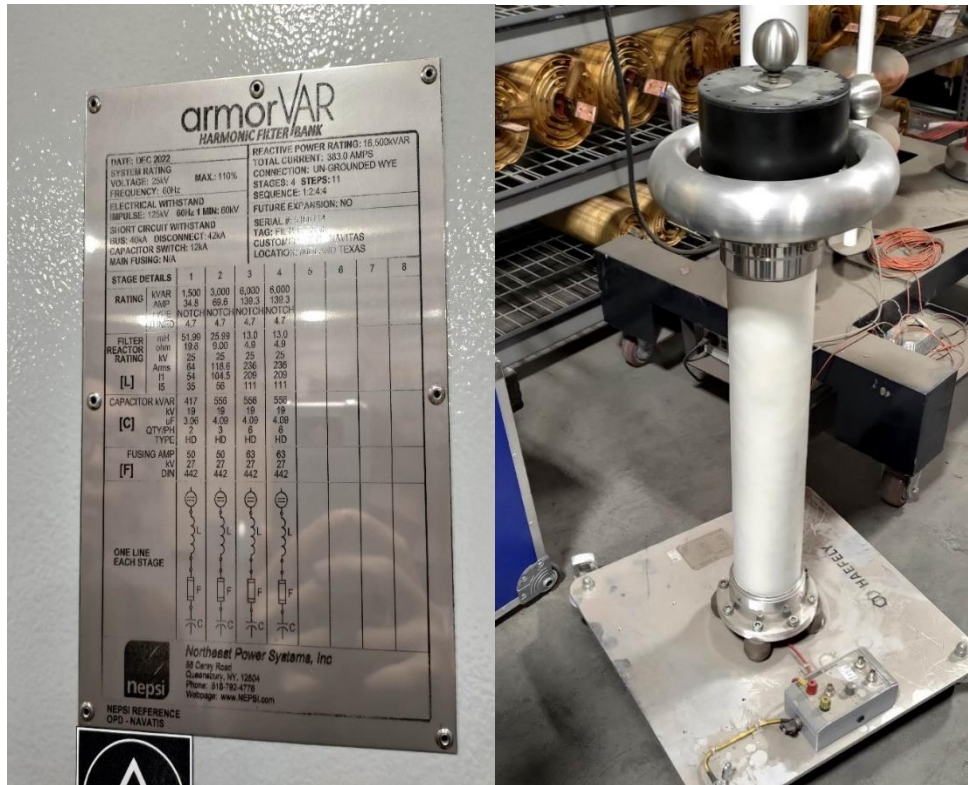
圖47 部分放電檢測設備與諧波濾波器銘牌
