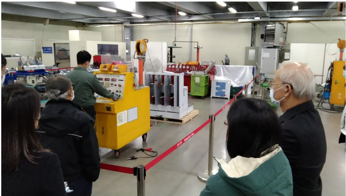
圖 25 主回路商頻耐電壓試驗
