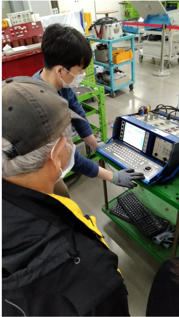
圖 27 機械開閉及特性試驗
