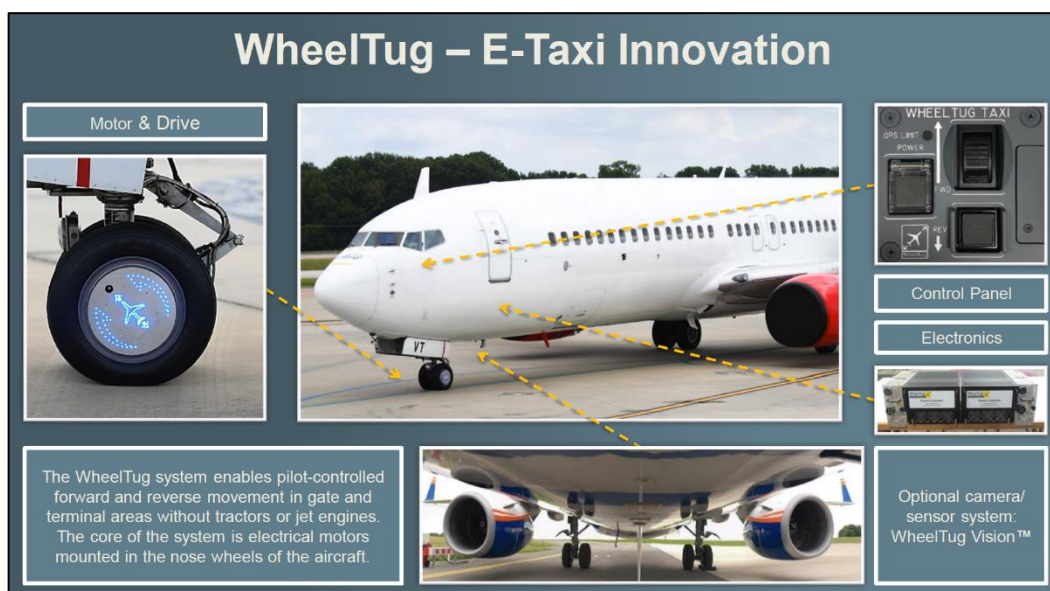
圖 20 WheelTug 研發航機電動滑行系統新技術
