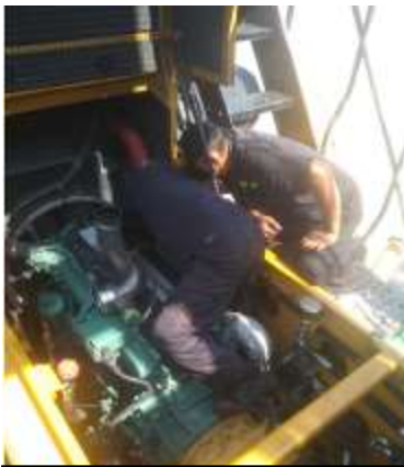
渦輪管斷裂更換
