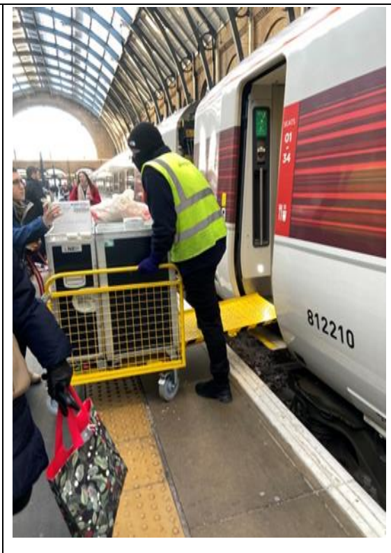
圖 3.4.28 使用渡板協助大件物品的運送，減少人員搬運大件行李的人因危害
