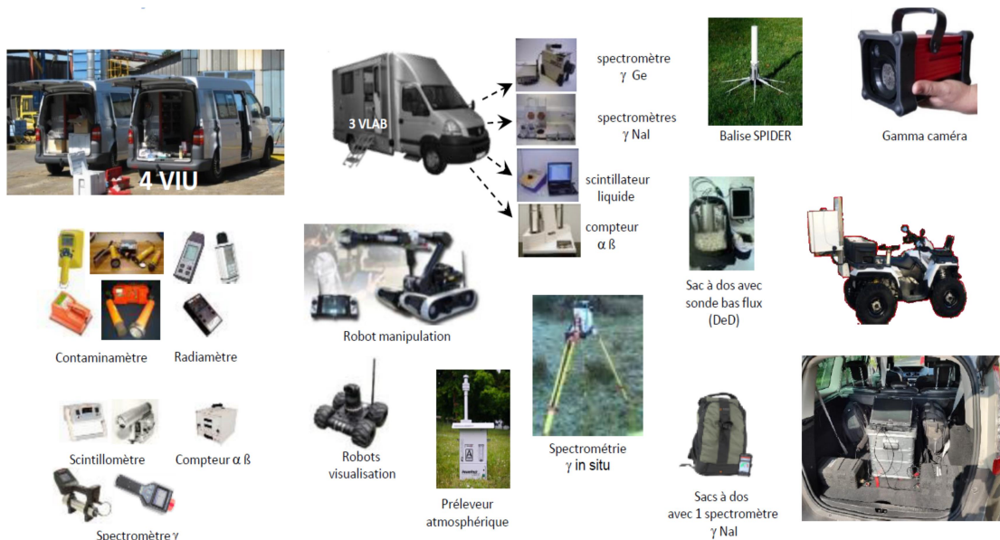
圖 21：IRSN 危機機動小組之各式輻射偵測儀器及設備
