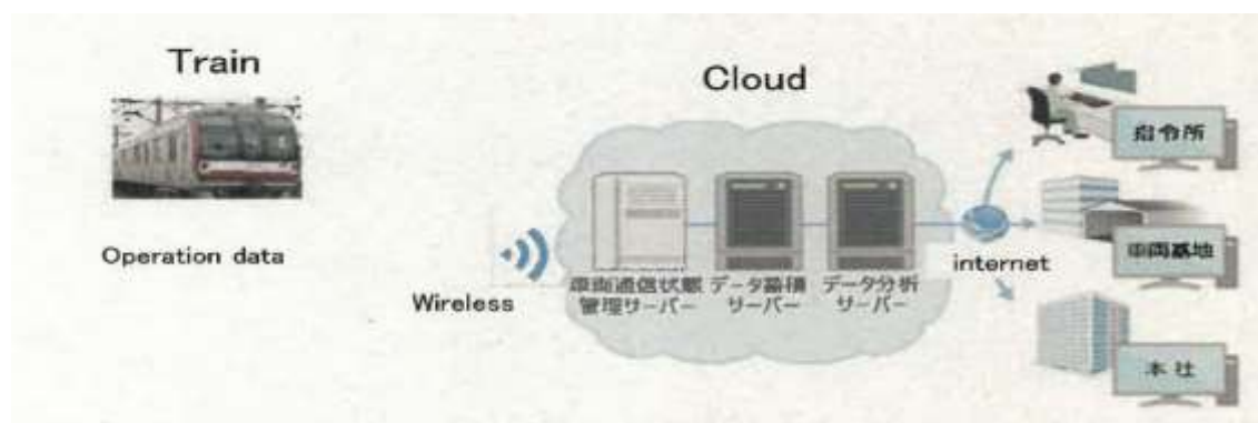
圖 3.1.6 東京地鐵車載軌道狀態監測系統(國土交通省簡報)
