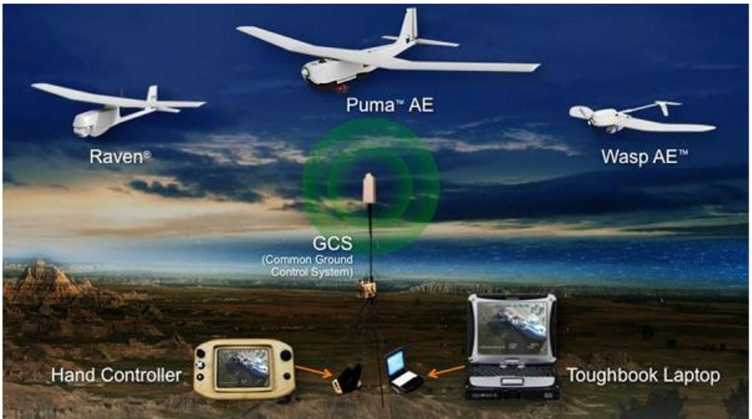
美國航空環境(Aero Vi rement)公司目前所研發 3 種機型：Raven(RQ-11B)、Puma AE(RQ-20)及 Wasp AE (RQ-12A)除機型不同外，操作介面與方式均共用、相同，大幅減少人員訓練成本與增加裝備調度運用之靈活性。
