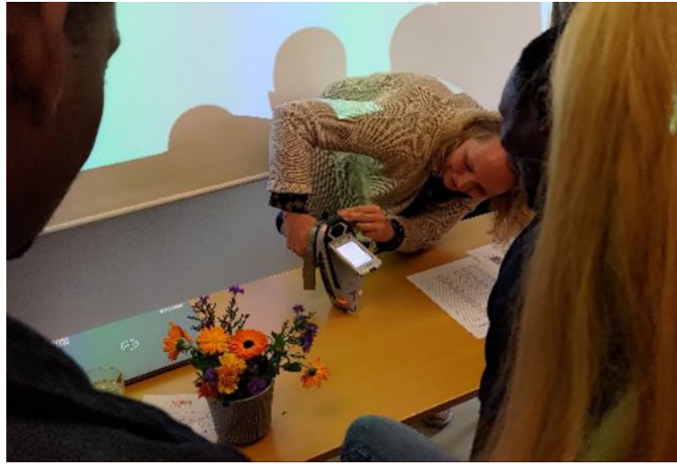
圖 15、KEMI 講師 Kerstin Gustafsson 示範使用 XRF 快篩儀器執行製成品重金屬含量快篩
