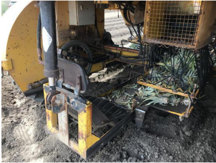
圖 7. 鳳梨種植機械操作人員作業位置及鳳梨苗放置處
