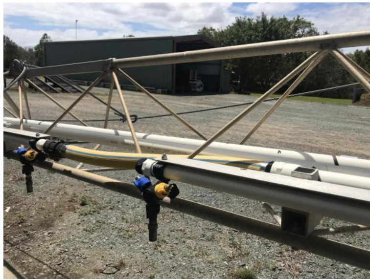
圖 10. 利用出水裝置調配灌溉、施肥及用藥管線，控制作業範圍並避免汙染及資源浪費
