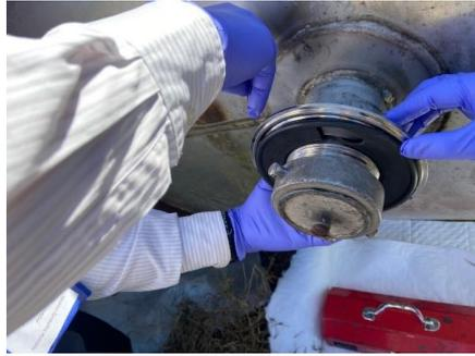
圖 21. 於車頂閥件上安裝連接器與墊片
