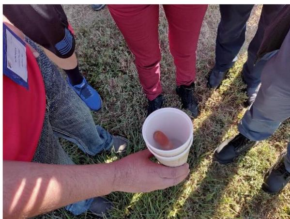
圖 1. 外部物質接觸到液態 LPG 的情況 (結凍與碎化)
