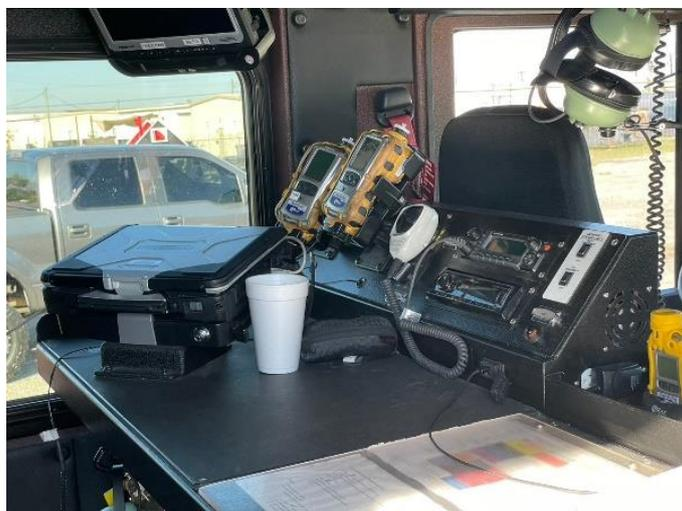
圖 7. 偵檢設備 2 (五用氣體)
