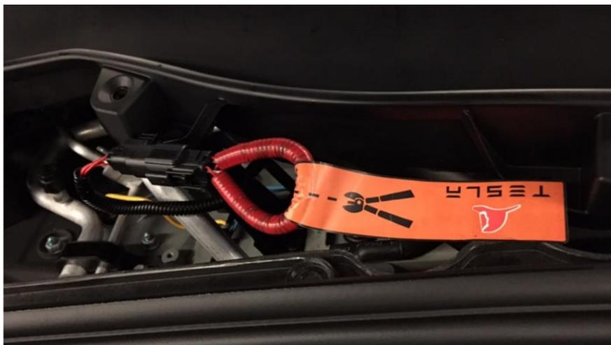
圖 50. 電動車斷電裝置
