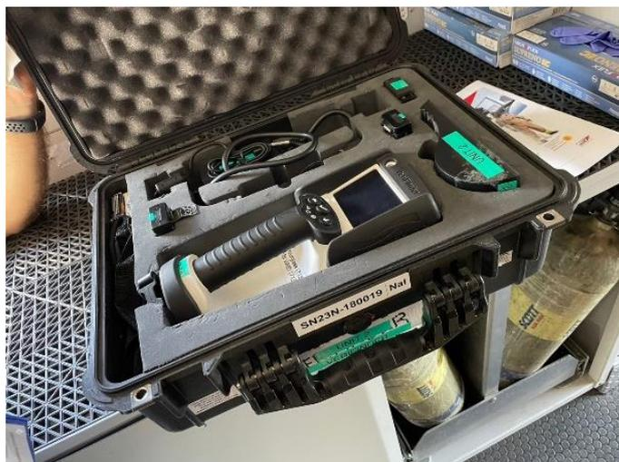
圖 6. 偵檢設備 1 (輻射偵檢儀)
