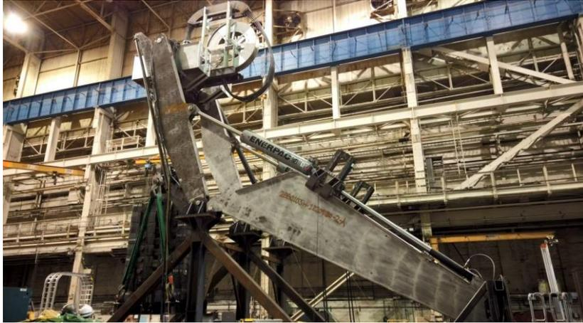
圖三（一）4、三號機燃料廠房 HI-LIFT 防止單一失靈吊車
