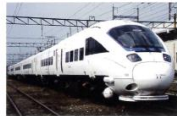
九州旅客鉄道 株式会社股納 885系 振り子式交流特急電車 Series 885 AC Tilting Limited Express Train EMU for Kyushu Railway Co.
