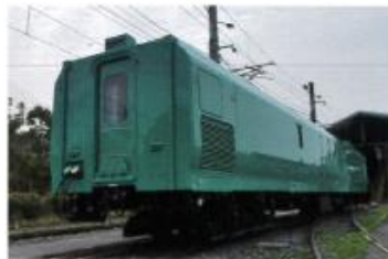
北海道旅客鉄道 株式会社股納 マヤ35形在来線用軌道検測車 Track Inspection Car for Hokkaido Railway Co.
