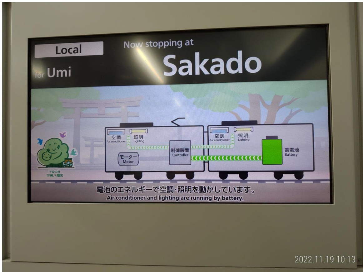
行駛中或停車時皆以蓄電池電力供應列車設備(空調、照明、牽引馬達、控制等)所需電力
