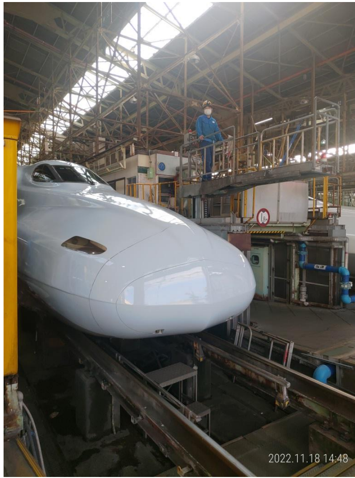
列車前端維修用移動式工作平台
