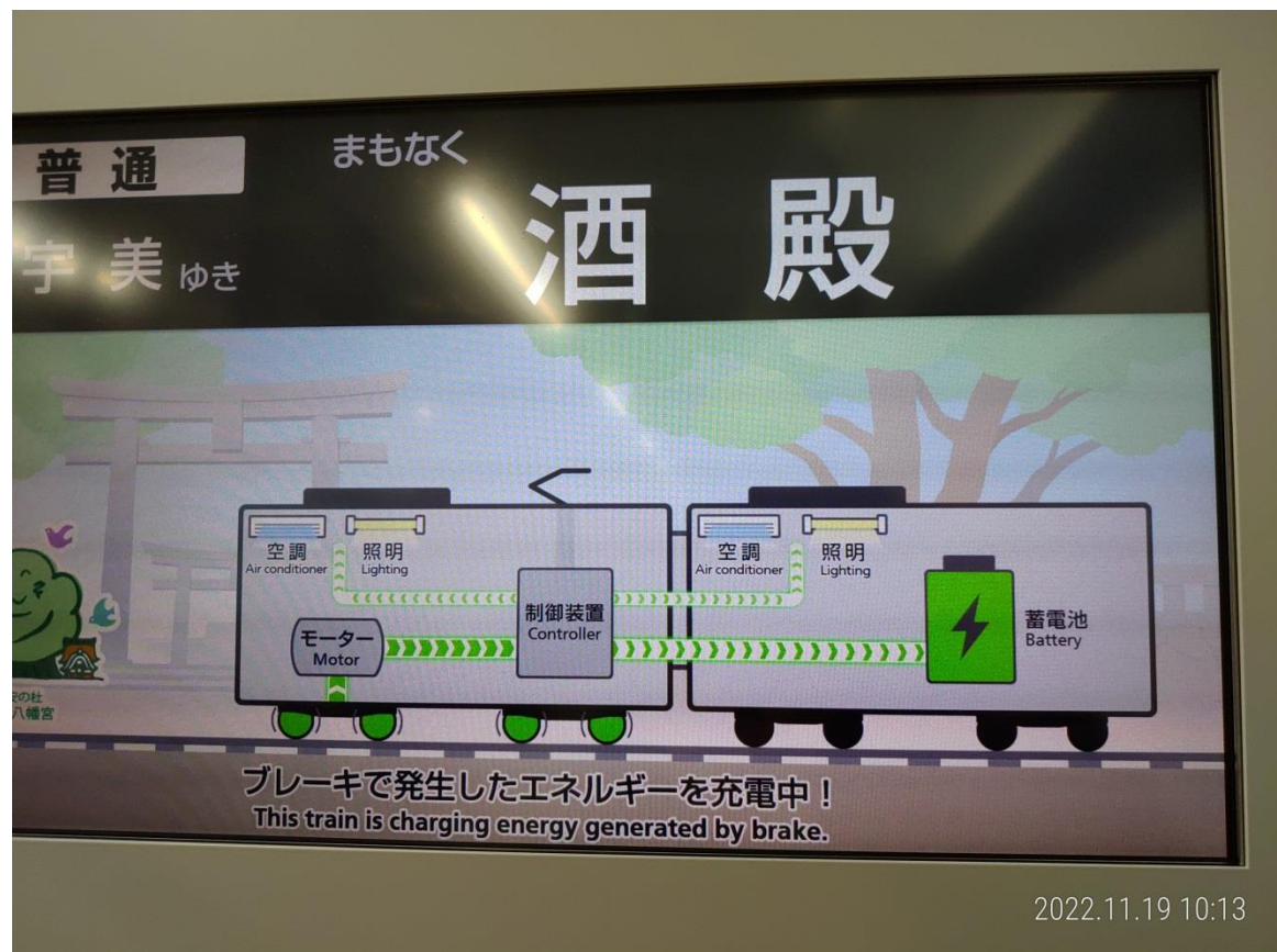
列車設計以牽引馬達電軔方式減速，回饋電能向蓄電池充電
