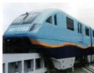
シンガポール セントーサ開発公社殿納 モノレール車両 Straddle Type Monorail EMU for Sentosa Development Corporation, Singapore.
