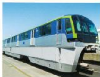
東京モノレール 株式会社殿納 10000形 モノレール車両 Type 10000 Straddle Type Monorail EMU for Tokyo Monorail Co., Ltd.
