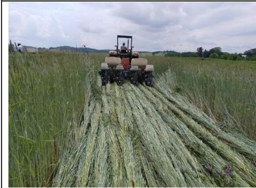
圖 7. 曳引機前方附掛滾壓式輾草設備，後方附掛播種機。田間滾壓式輾草及播種情形。
