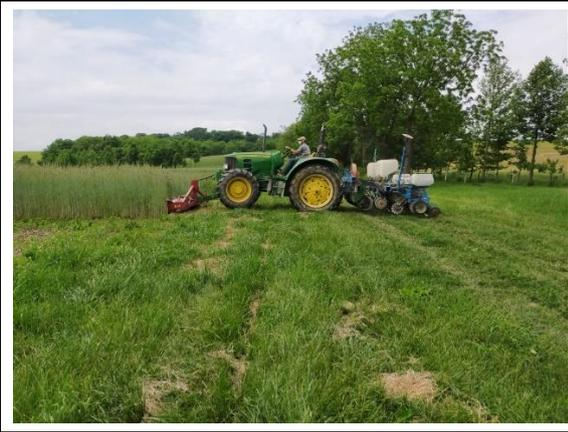
圖 6. 曳引機前方附掛滾壓式輾草設備，後方附掛播種機。
