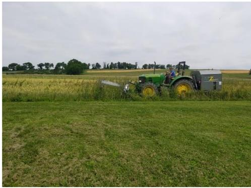
圖 13. 曳引機附掛前方電擊除草機，後方發電機。
