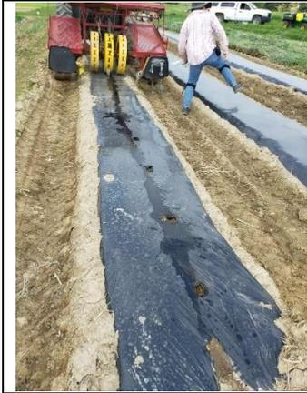
圖 5. 曳引機附掛施肥打洞機，於雜草抑制蓆 PE 布打洞及施用液態肥料情形。
