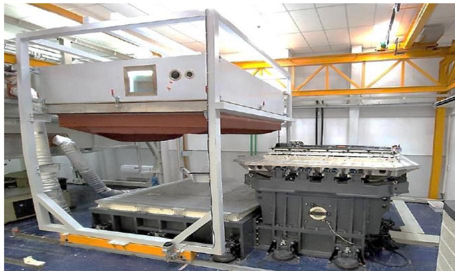
圖 19. 電動車電池系統振動試驗
