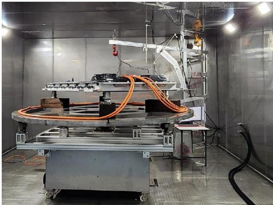
圖 21. 電動車電池系統雨淋試驗
