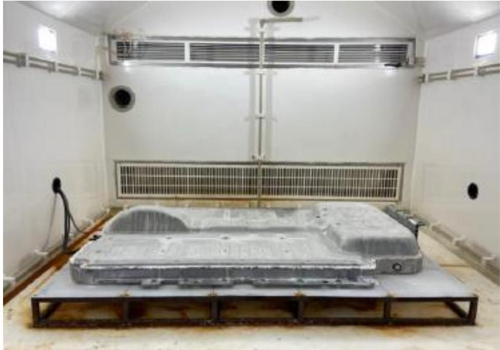
圖 20. 電動車電池系統鹽霧試驗
