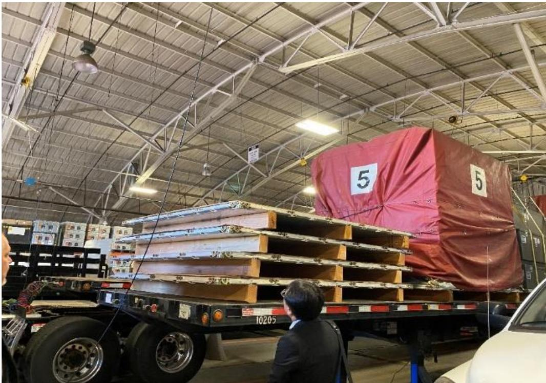
圖 31 攜行箱可繫結在貨架上，並以固定裝置避免滑落
