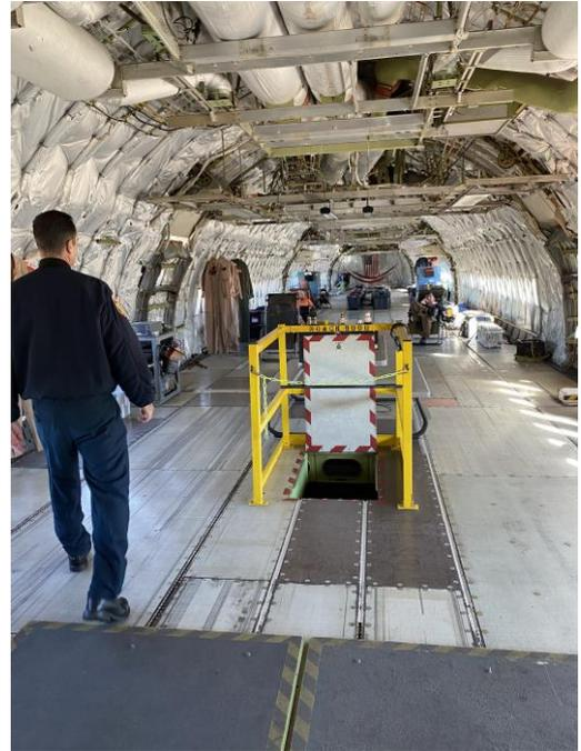
圖 37 水箱消防飛機 DC-10 及艙內示意圖
