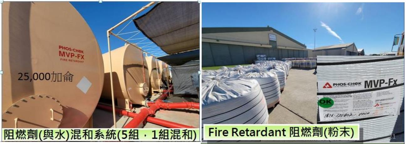
圖 44 阻燃劑及阻燃劑混合系統示意圖
