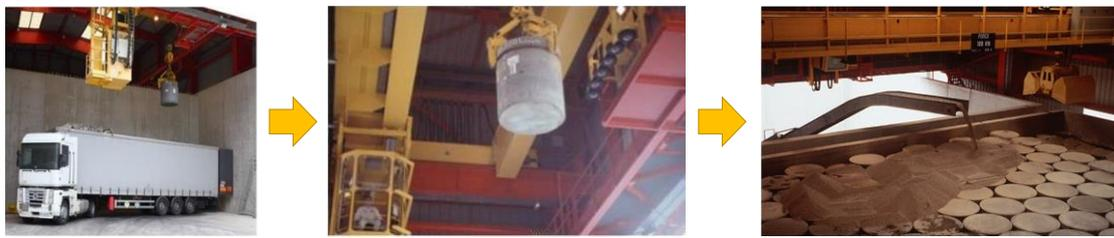
圖 3.3-3 CSA 混凝土盛裝容器處置流程
