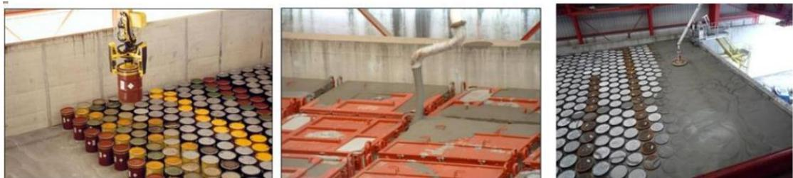
圖 3.3-4 CSA 金屬類盛裝容器處置流程
