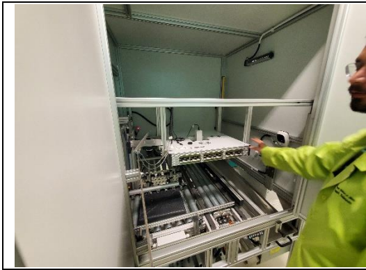
小型輸送帶系統-具多種感測器
