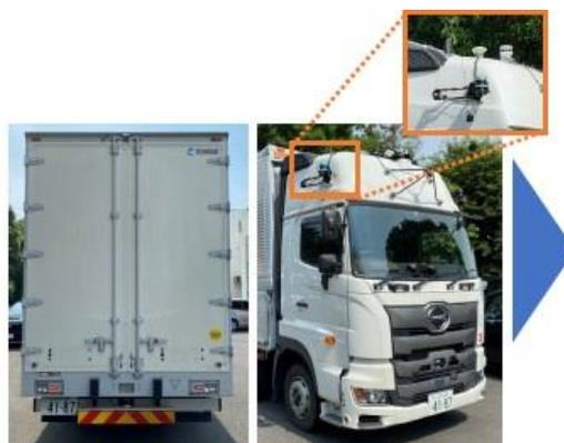
圖 11 「RoAD to the L4」第二東名高速道路自駕卡車照片
