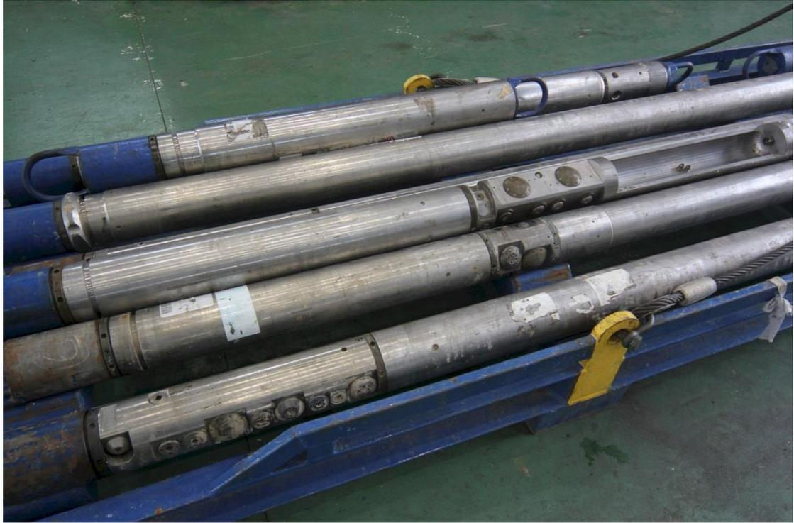
圖 28 井下電測感應設備近照
