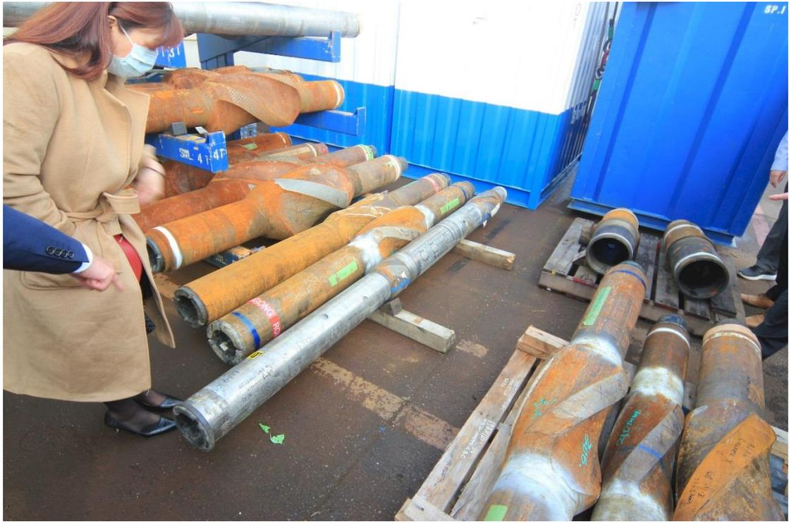
圖 24 LWD 感測設備（圖中銀色桿狀物）
