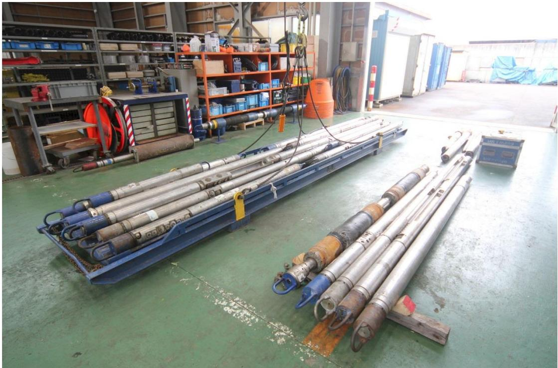
圖 27 井下電測感應設備
