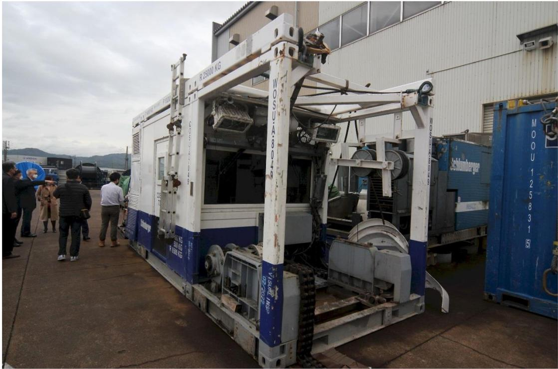
圖 30 可移動式井測監控室
