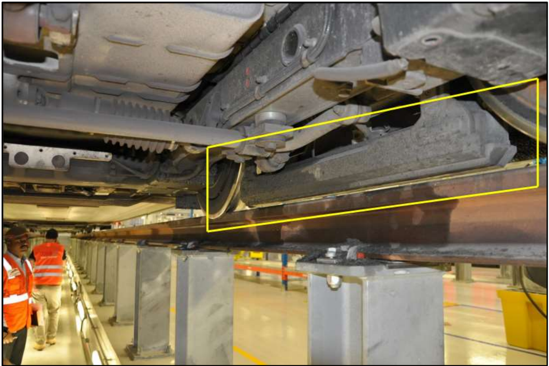
圖 47 磁力煞車及磁軌
