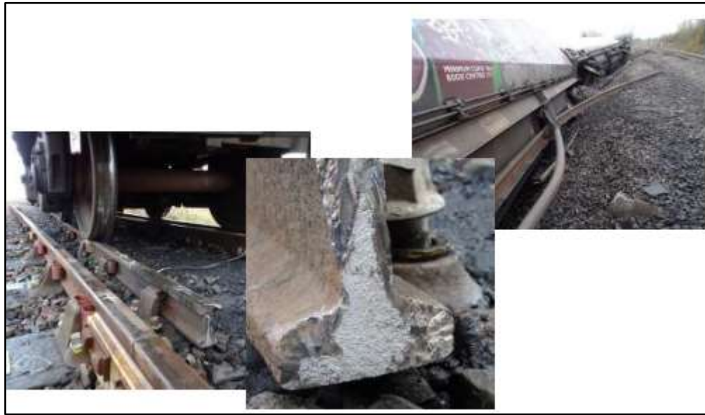
圖 28 軌道損壞情形之觀察
