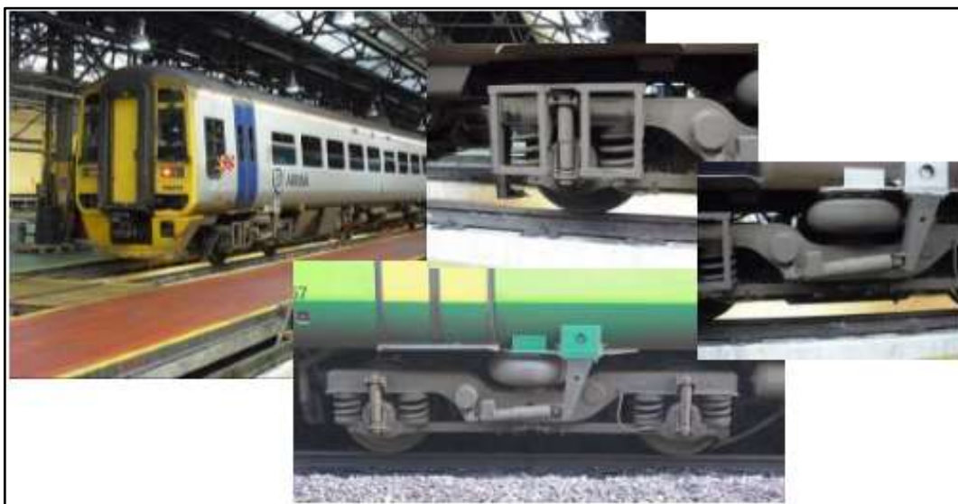
圖 13 列車車廂、彈簧和阻尼器
