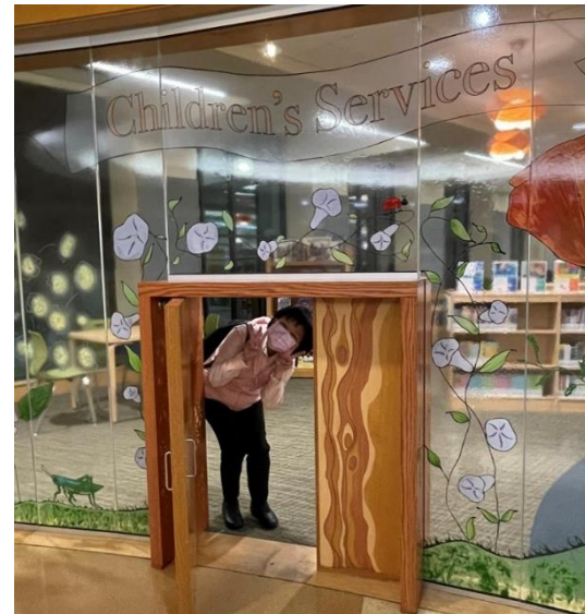
圖 107：幼童區以透明玻璃牆區隔，館員可自該區外觀察內部情形。該幼童區以小的低矮門區隔，可以發揮區隔其他年齡於外之作用。玻璃牆貼附透明紙列印之繪畫，美觀兼防止誤撞之安全防護作用
