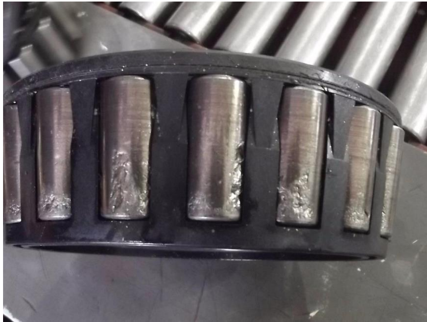
由聲學監測系統發現之早期軸承損毀情形
