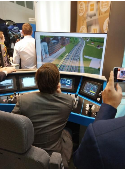
駕駛模擬系統，可依據不同車型配置駕駛室
