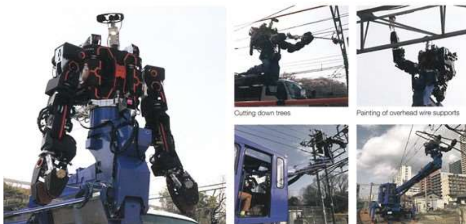
圖 29 多功能鐵道重型維修設備
