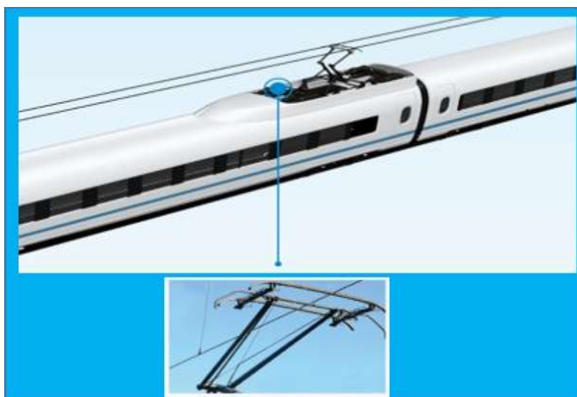
圖 28 集電弓影像偵測
