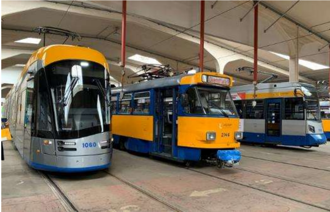
圖 4 萊比錫輕軌車輛（由左至右：NGT10、T4D-M、NGT6）
