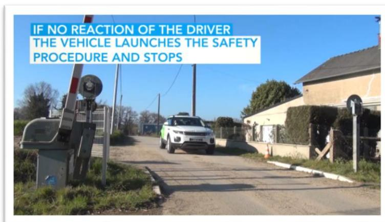
圖 24 場景三：平交道故障測試-2
