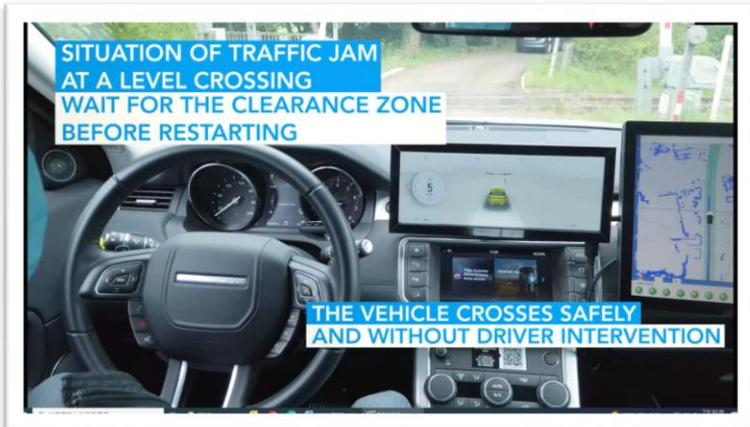
圖 22 場景二：開放平交道+堵車測試-2
