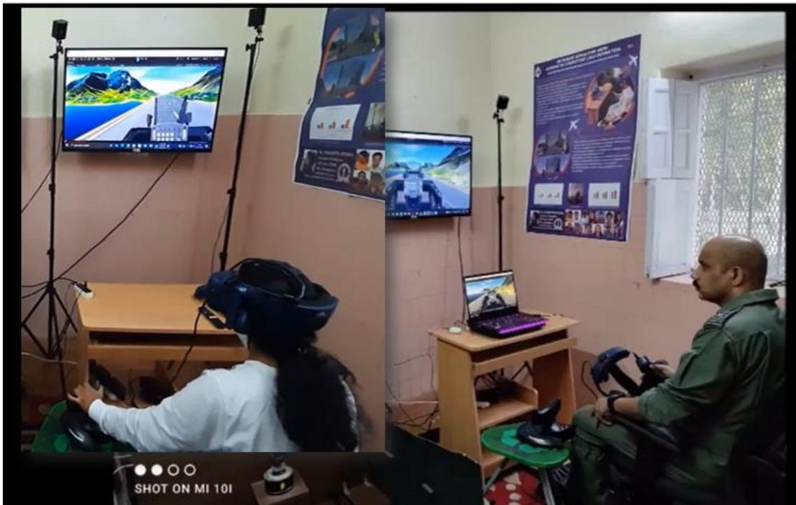
圖 3-9 受測者配戴 HTC Vive Pro Eye 與腦波儀執行虛擬飛航操作實驗圖
