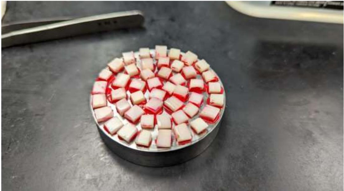
切成截面積 5 平方 mm 的實驗檢體後，會再將檢體精細修整。
