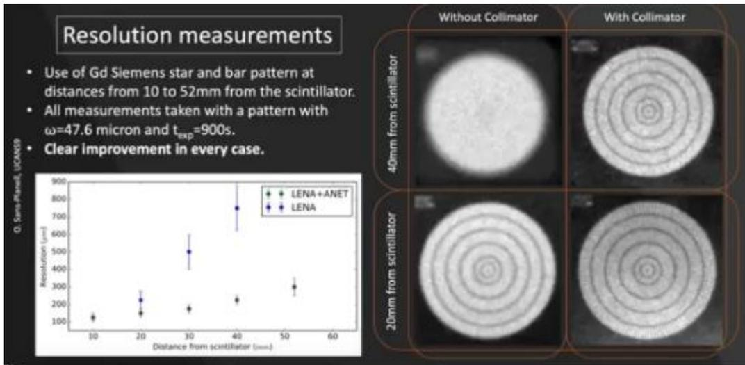
圖 7 加裝準直器與未加裝準直器的影像解析度比較
