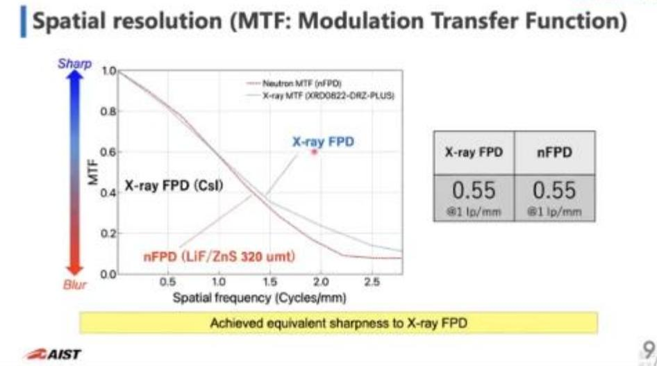
圖 14 中子平板式偵測器設與 X 光平板式偵測器空間解析度比較
