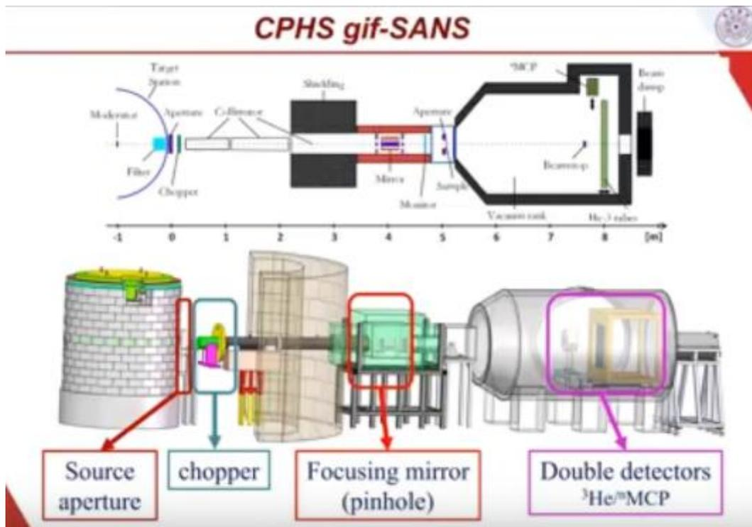
圖 2 低掠角聚焦小角度中子散射儀距離位置圖與外觀示意圖
