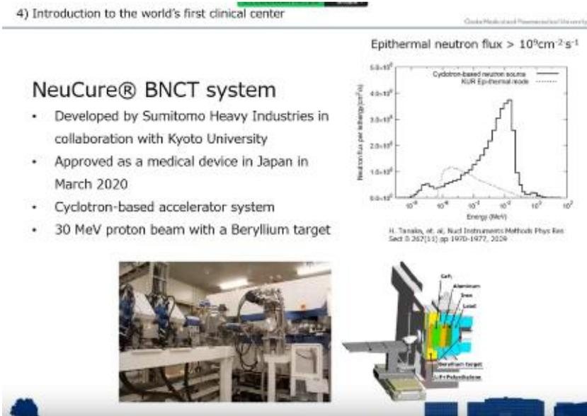
圖 28 世界第一套可治療用 BNCT 系統加速器實機與病床設計圖
