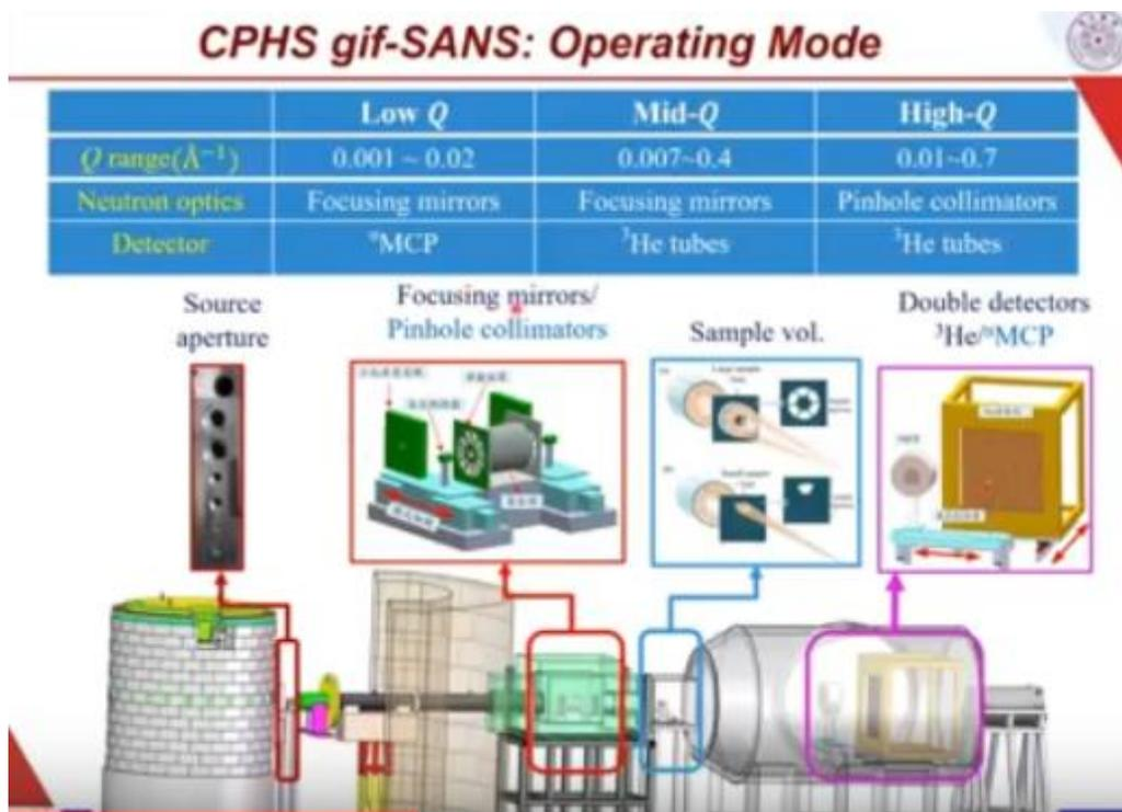
圖 3、低掠角聚焦小角度中子散射儀操作模式
