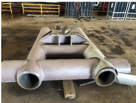
艏十字纜樁不鏽鋼板包覆
