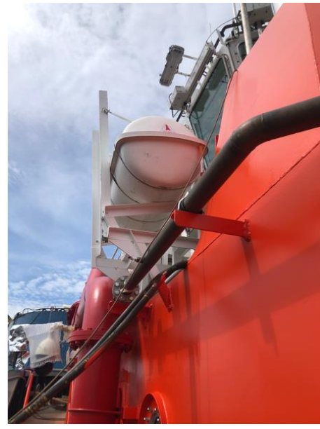
救生筏安裝完工
