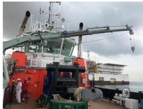
吊桿功能測試
