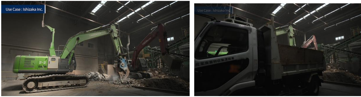
圖 24 石坂產業公司的工地重型機具自動駕駛案例
