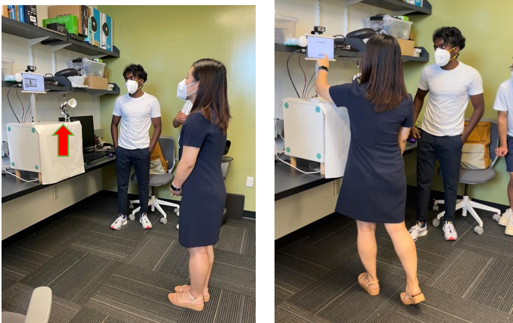
《圖》觀看示範影片後執行動作，螢幕上方攝影機偵測動作是否標準，紅箭頭處為社交機器人可給予反饋
