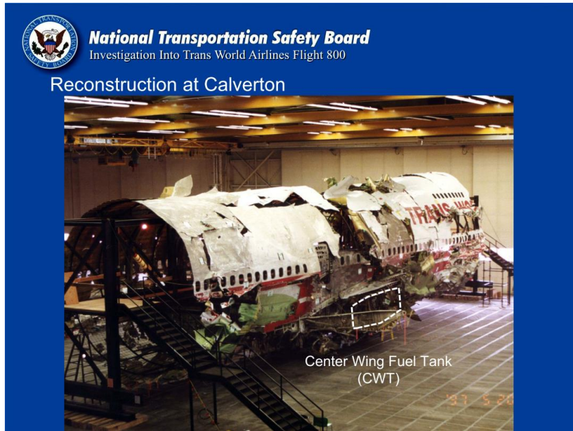
圖 2.4-7 存放於 NTSB 訓練中心之 TWA-800 航班重建殘骸
