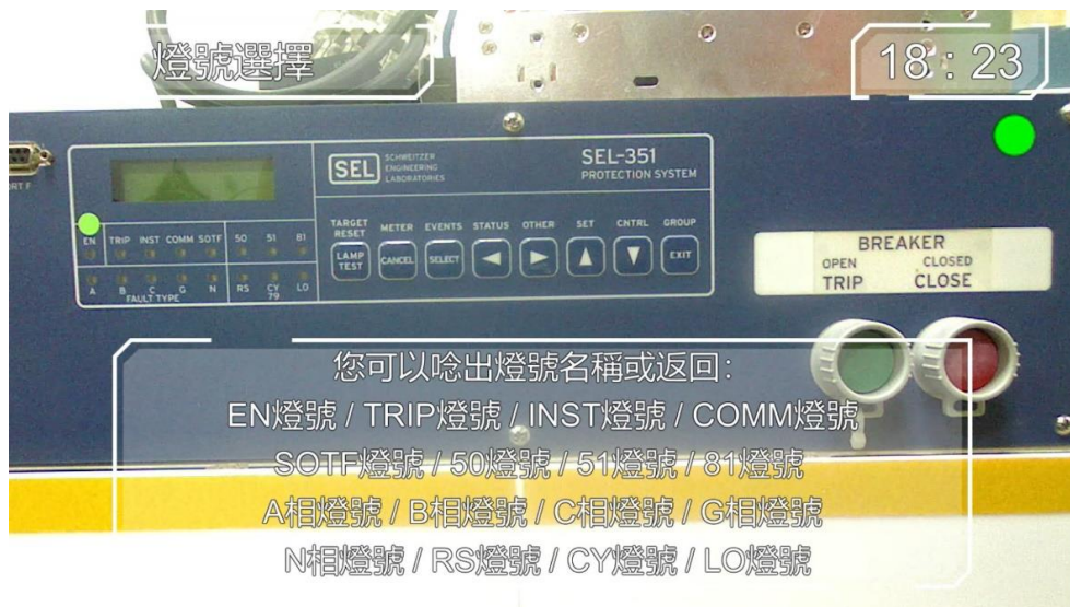
圖 5 應用 MR 混合實境於 IED 電驛輔助操作系統教學
