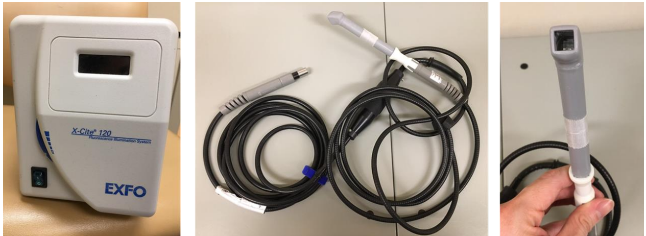
圖七 朴芳瑀醫師所使用的光動力治療(PDT)工具 LED，圖左為機器圖中為導線，圖右是會發出藍光的探頭，它的光源設計是凹陷於外殼中的。
