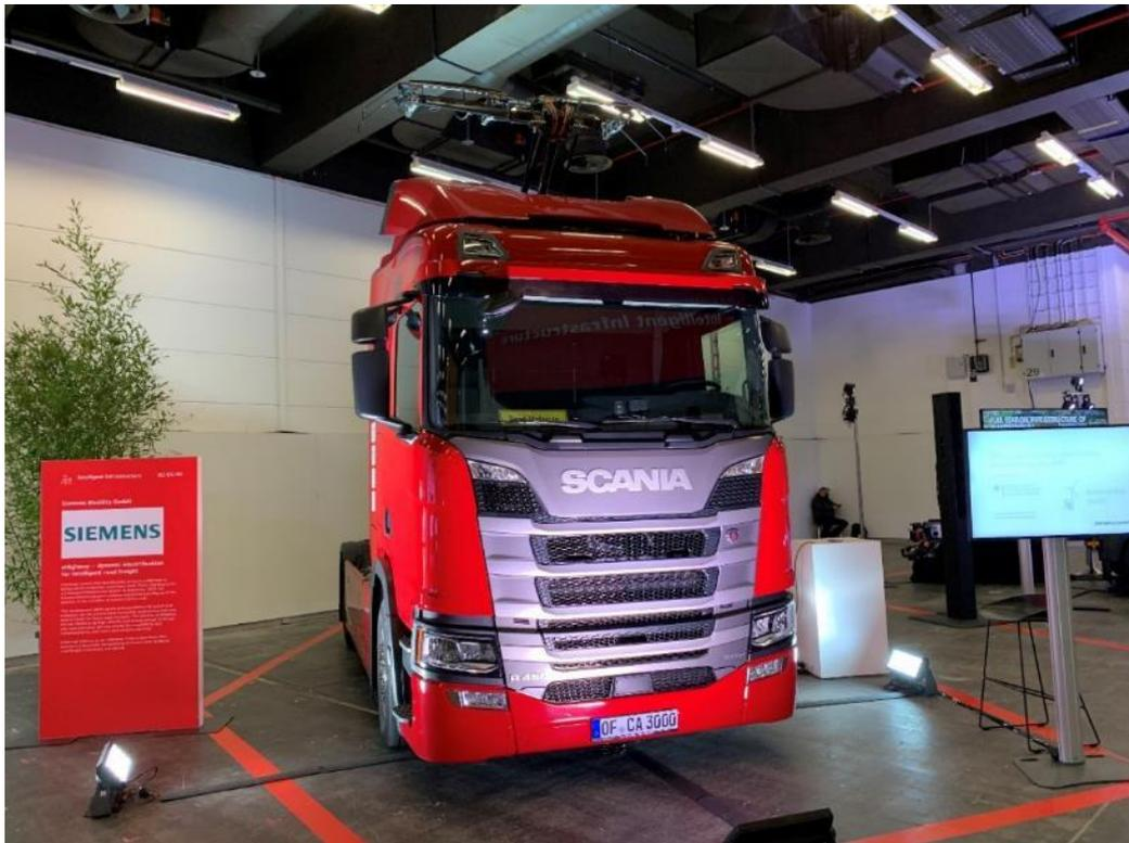
圖 23 架空線電力大貨車(eHighway)
