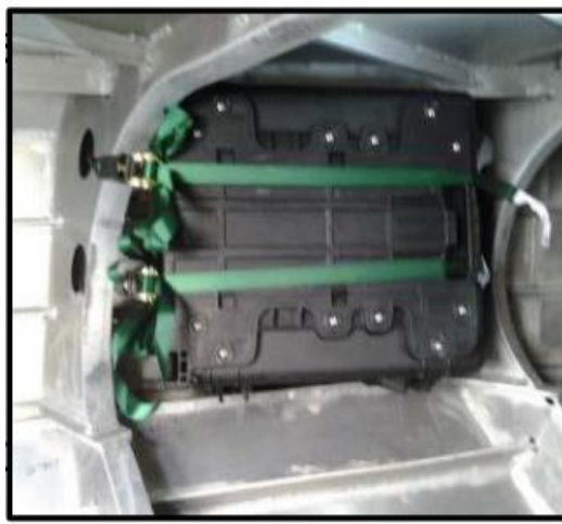
圖：小型船舶非接觸偵測系統安裝於巡防艇船殼內部
