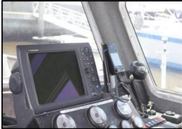
圖：小型船舶非接觸偵測系統駕駛台控制面板
