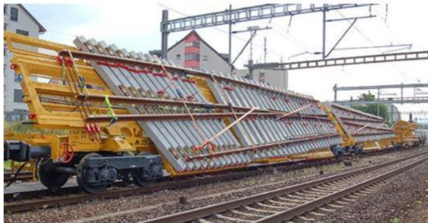
圖 7、道岔模組化運送工程車
