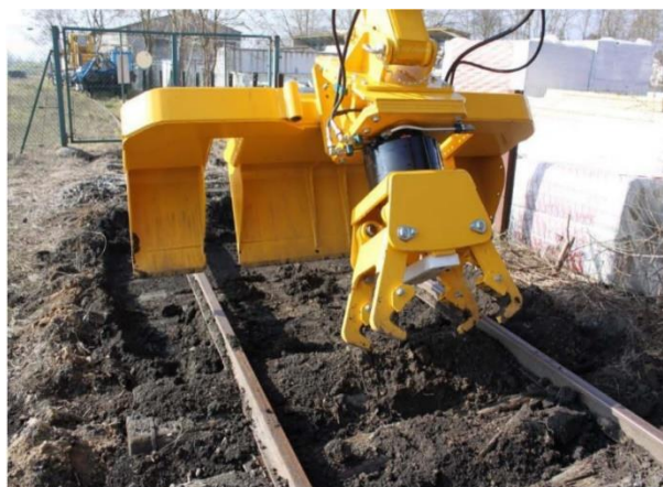
圖 6、軌枕更換專用工具
