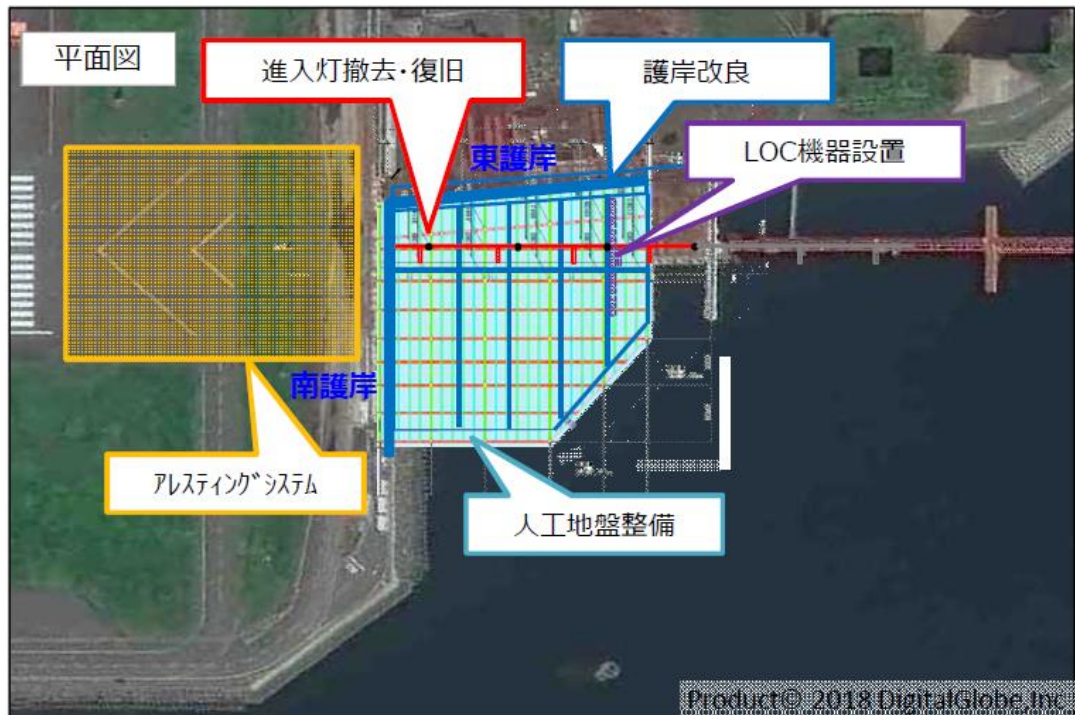
圖 3.3.6 A 跑道左右定位台、電波反射用地及攔阻系統位置圖
