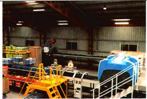
果實噴施殺菌劑，乾燥後經由機器影像辨識果實外觀品質
