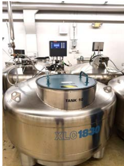
圖 13. 液態氮桶由監測器 24 小時監控，並可自動填充液態氮。
