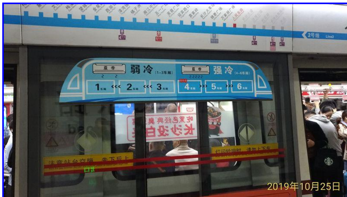
圖 3-2.7 車廂空調設置分區溫度
