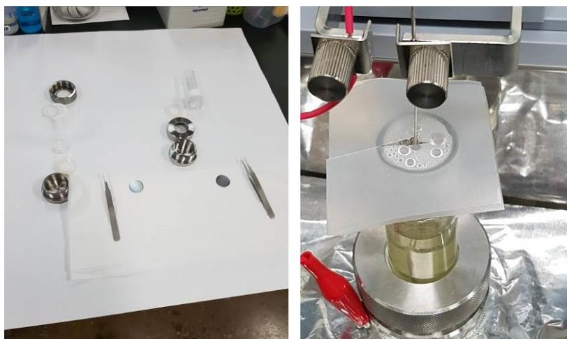
圖 15. 電鍍材料拆解（左）及電鍍中樣品（右）
