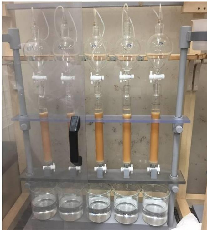
圖 34. 進行銻-90 放射性分析以交換樹脂除去鈣，再以醋酸鈉溶液流洗出銻-90
