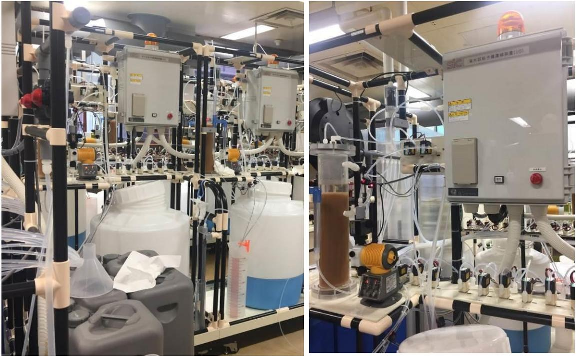
圖 32. 海水過濾裝置，利用管柱進行流洗過濾
