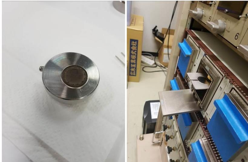
圖 16. 電鍍片及以  $\alpha$  射線能譜儀測量活度
