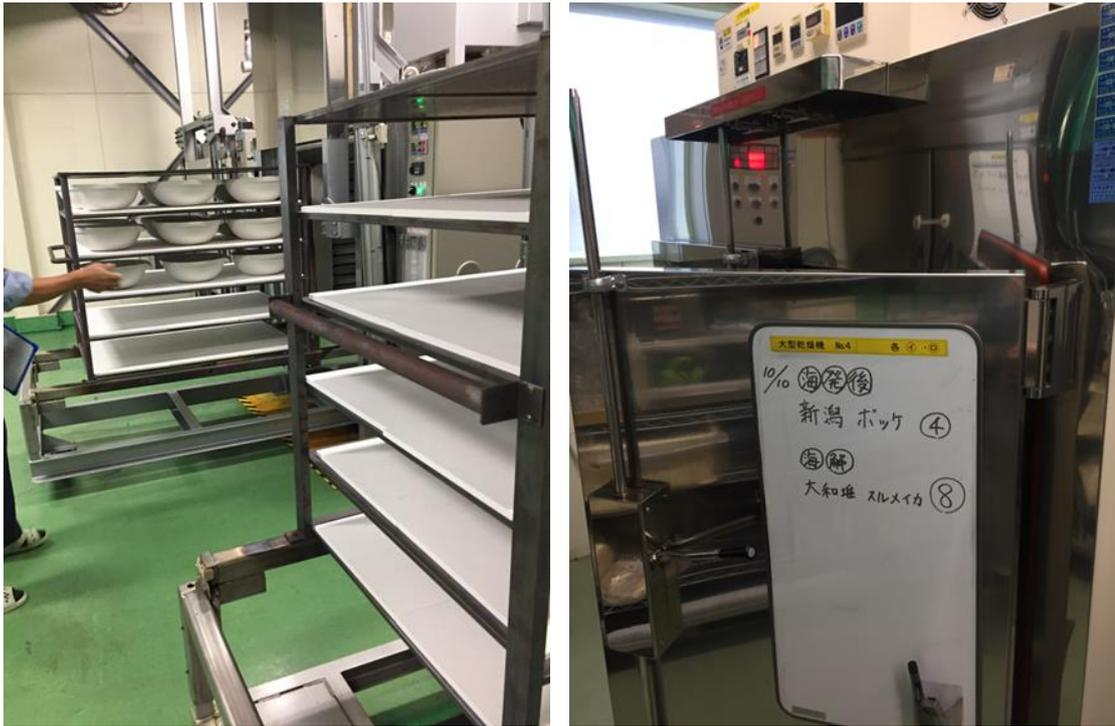
圖 29. 高溫爐與試樣乾燥箱，白板上紀錄放置日期與試樣名稱
