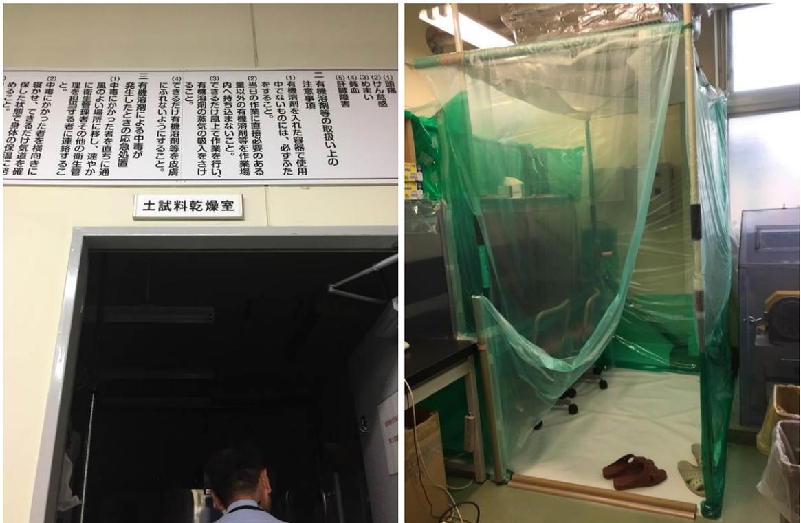
圖 33. 土樣前處理/乾燥室（土樣於隔離區進行前處理，避免粉塵污染實驗室）
