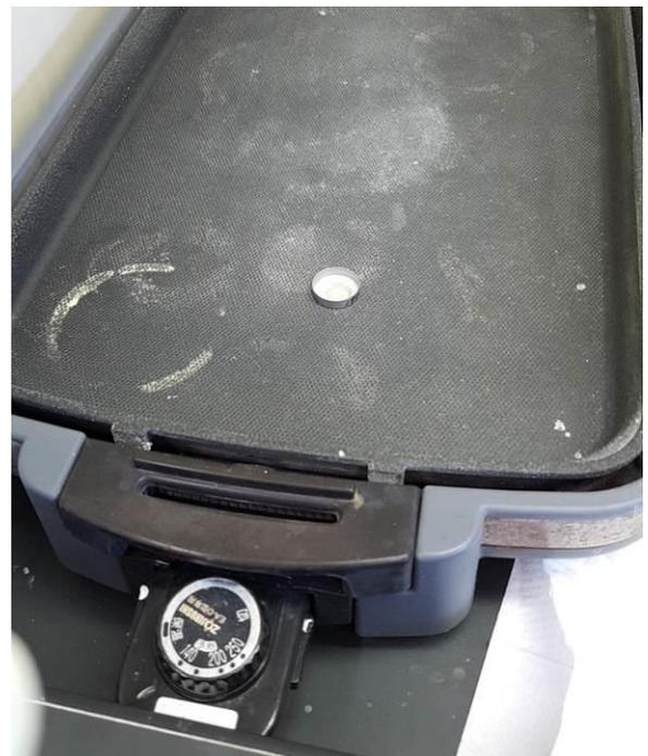
圖 24. 蒸乾後以 1:15 硝酸清洗燒杯瓶壁並轉移至不鏽鋼盤
