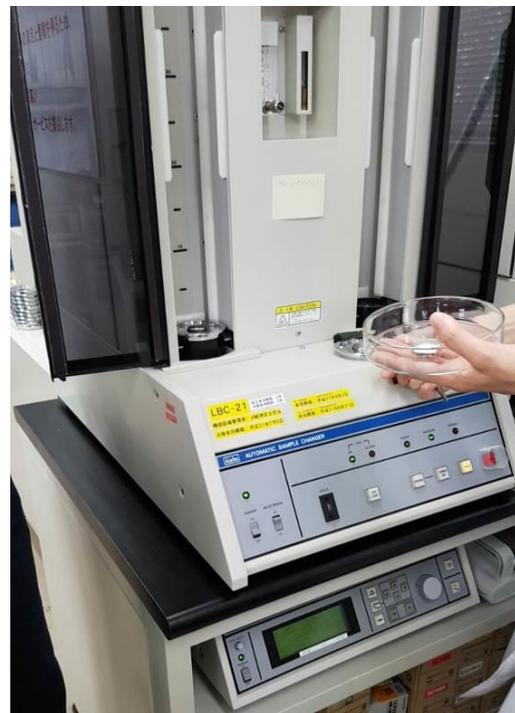
圖 26. 左圖蒸發皿左不銹鋼盤為中心樣品，右側為日方樣品，使用同一台 LBC 計測
