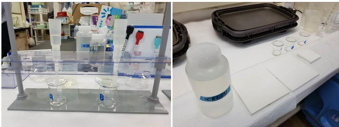
圖 13. 濾液通過 eichrom Sr Resin 收集鉛溶液
