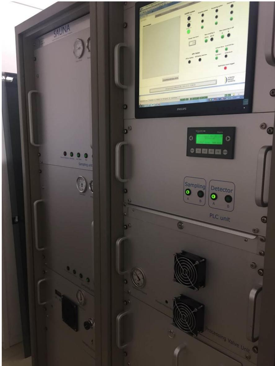
圖 37. SAUNA II 核爆檢驗儀器，偵測大氣中放射性惰性氣體 Xe 之含量比
