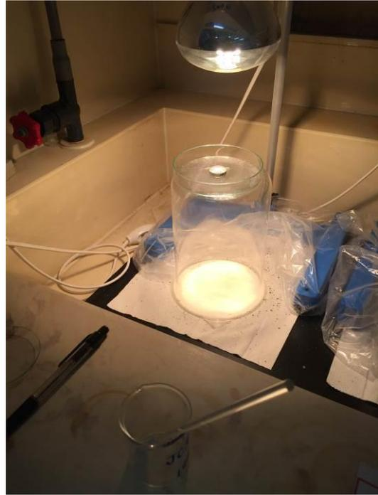
圖 25. 左圖為本中心以本生燈烤乾不鏽鋼盤方式；右圖為日方 infrared lamp 蒸乾
