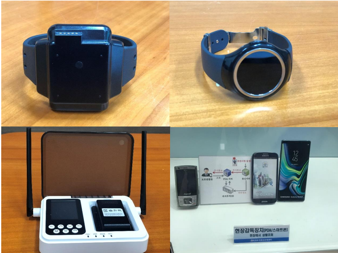
電子腳鐐(上左)、監控手錶(上右)、居家主機(下左)、手持追蹤裝置(下右)
