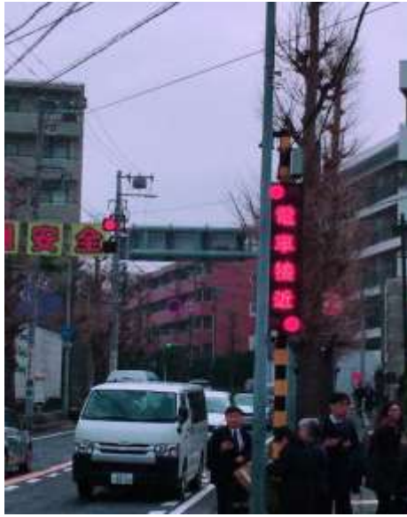
圖 3.2.3.2-2 共用路權段，設置電車接近顯示器
