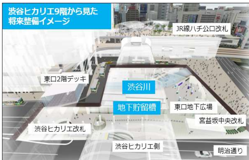
圖 3.4.2-6 渋谷車站下方設置大型儲水槽，期達抵抗暴雨水患功能
