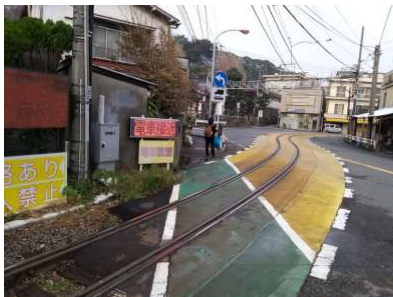
圖 3.2.3.2-1 進入共用路權段，設置電車接近警報器
