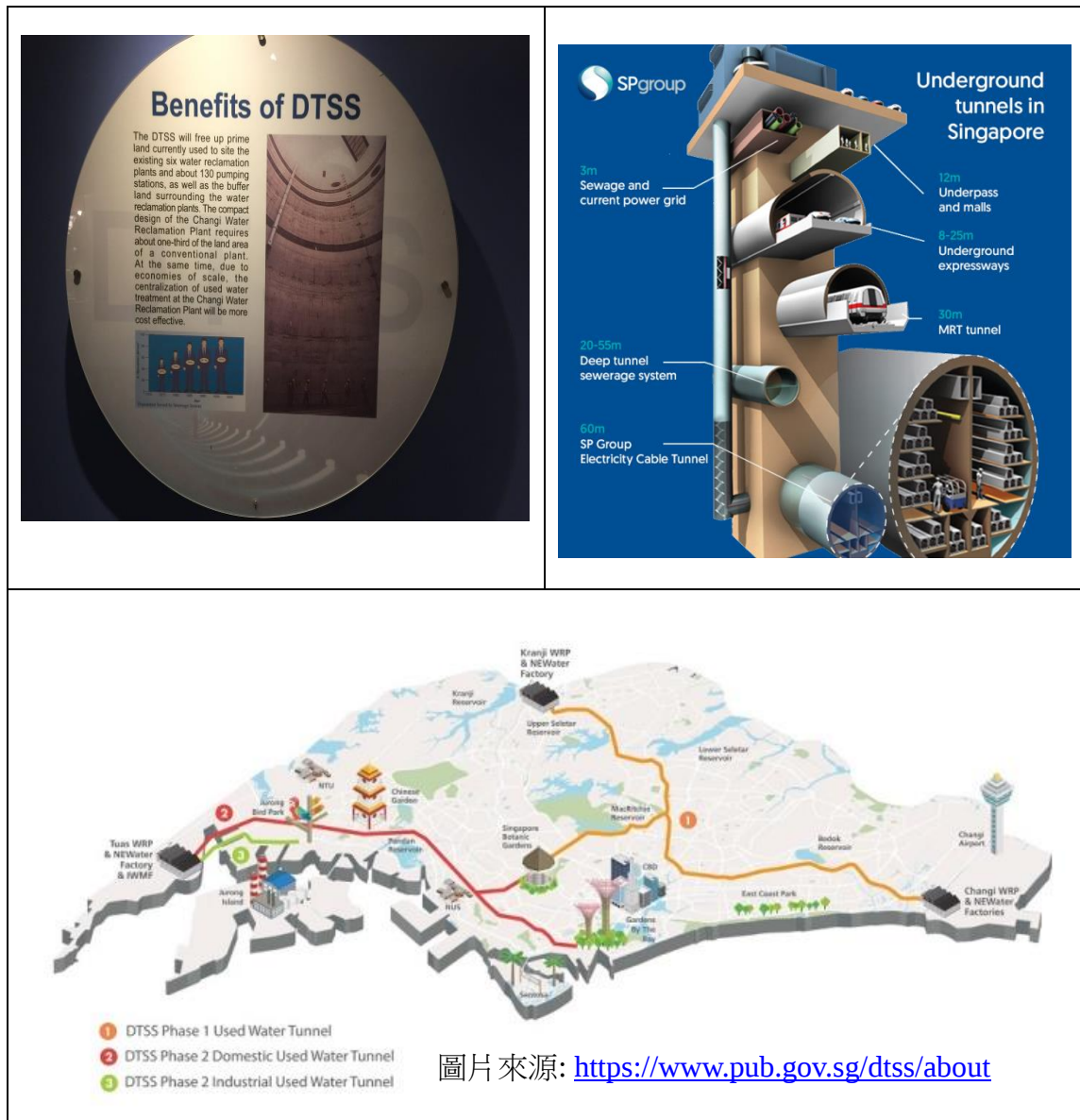
圖 8、新加坡深隧道路污水收集系統
